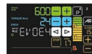
**Endodancia.** En este modo el sistema opcional de endodancia integrada optimiza la ergonomía de los tratamientos radiculares. Está compuesto por micromotor, funciones de Autostop, Autoreverse y Autoforward y localizador apical electrónico. Durante el tratamiento endodóntico, la consola a
