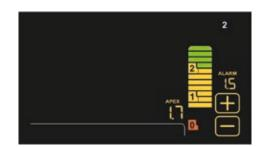
Apexlokalisator. Während des Einsatzes der Instrumente für die Wurzelkanalbehandlung wird der Abstand zum Apex auf dem LCD-Display angezeigt. Die Annäherung an den Apex wird von der ENDO-Software festgestellt. Wenn der Apex erreicht ist, wird die Drehung des Mikromotors von der Apex-Stop-Funktion unterbrochen.
